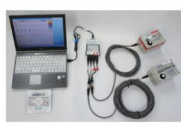
建物の常時微動を計測し、計測結果より求められた固有振動数をもとに、耐震性を客観的に評価することが可能です。
